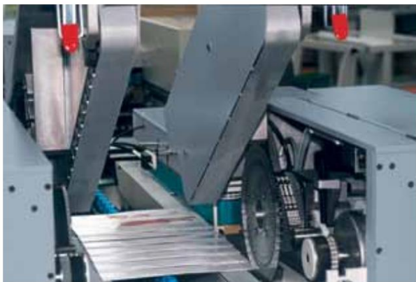
Faca superior com correia de prensagem aberta
